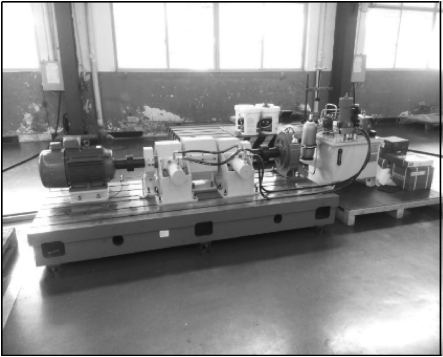
图 6 三相异步电机实验台
