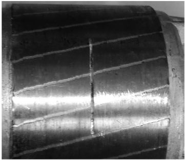
(b)断条故障转子
