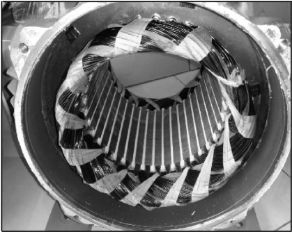
图 9 异步电机定子绕组匝间短路
