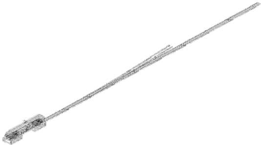
图 1 车辆-道岔耦合动力分析模型
